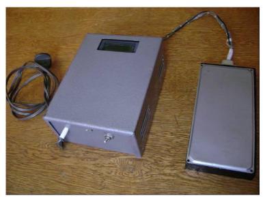
ЦИВ состоит из электронного блока (ЭБ) с цифровым дисплеем для индикации результатов измерений и выносного измерительного щупа (ИЩ).
